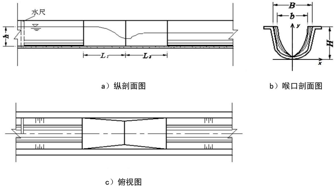
图 17 抛物线形喉口量水槽示意图
