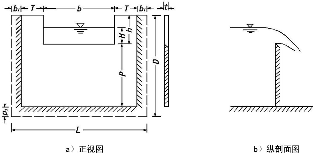
图 9 矩形薄壁堰示意图
