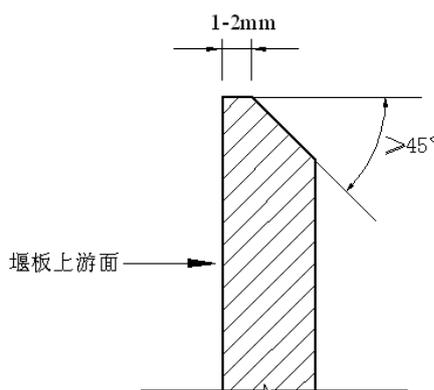
图 7 薄壁堰堰口锐缘加工图
