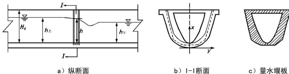
图 11 抛物线形移动式量水堰板的构造
