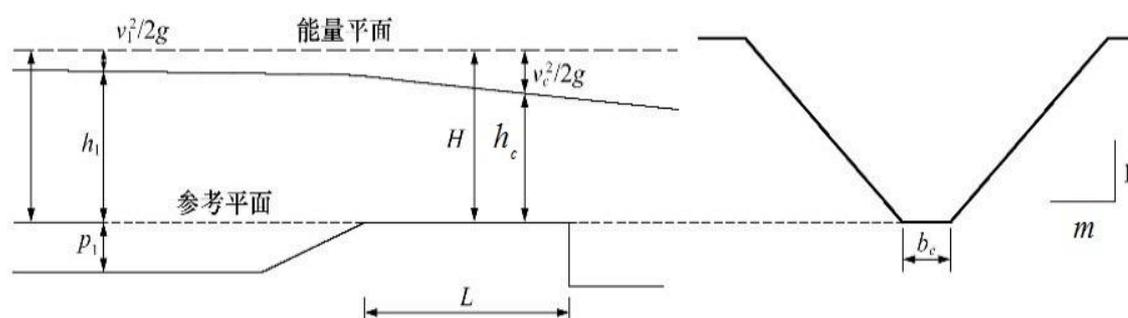
说明: 图中的变量意义参见图 20 说明。示意图为下游突降的简易量水槛, 其淹没度仅能达到 0.85。若渠道可用水头不足时下游宜采用 1: 6 的渐变段过渡, 淹没度可达 0.95。在自由出流条件下两者流量相同。
