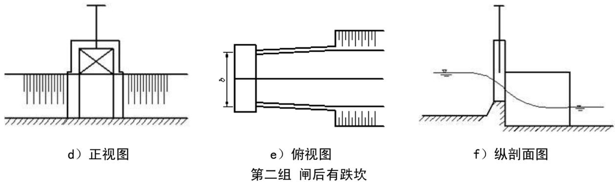
图 2 明渠直立式单孔平板闸示意图
