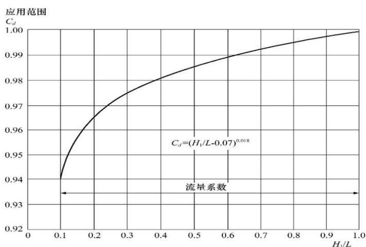
图 G.7  $C_d$  与  $H_1/L$  之间的函数关系图
