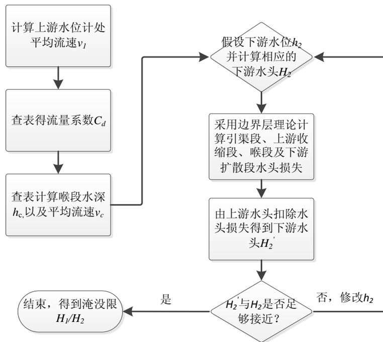
图 G.6 长喉槽非淹没限试算流程图
