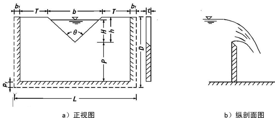
图 8 三角形薄壁堰示意图
