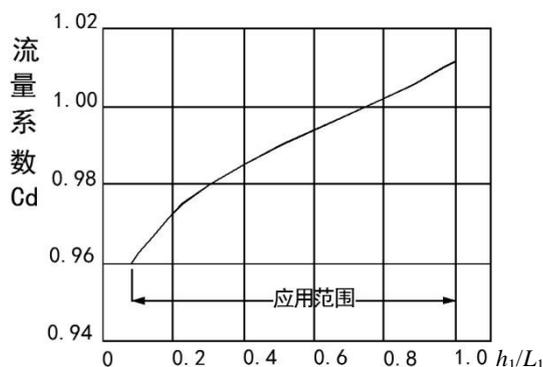
图 13  $C_d$  与  $h_1/L_1$  之间的函数关系图
