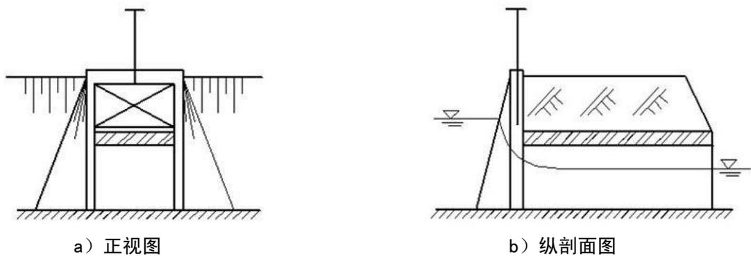
图 3 矩形暗涵直立式单孔平板闸示意图
