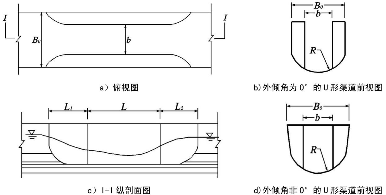
图 18 直壁式量水槽结构图
