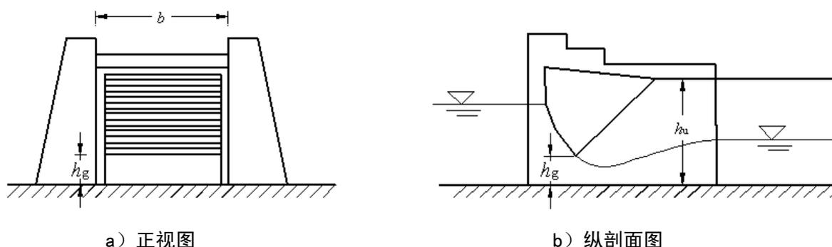
图 6 单孔平底弧形闸示意图
