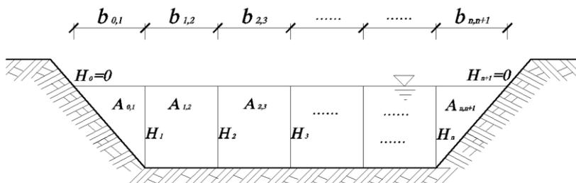
图 1 测流断面面积划分示意图
