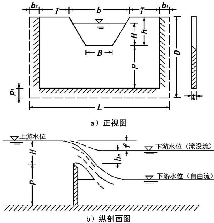
图 10 梯形量水堰及其水流形态示意图
