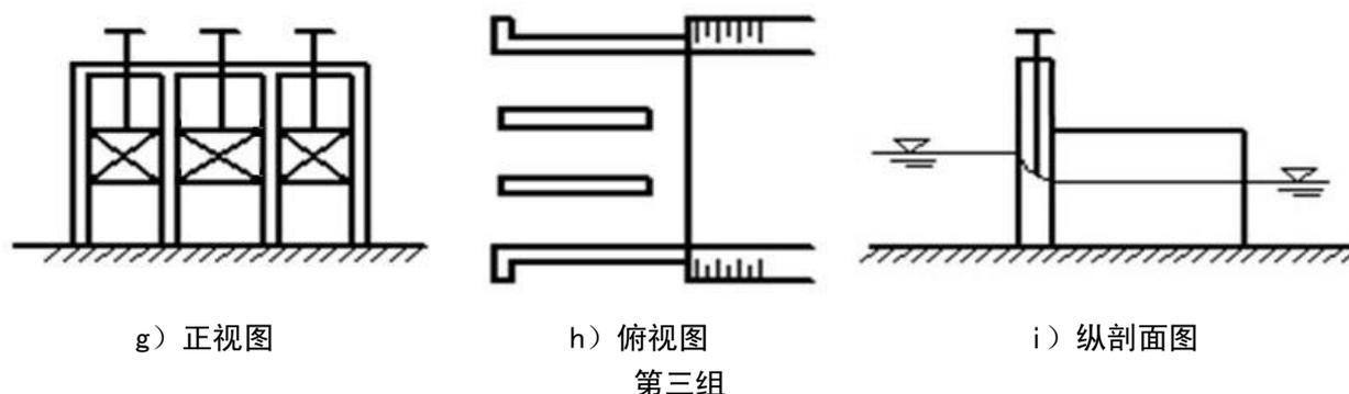
图 5 明渠矩形直立式多孔平板闸示意图
